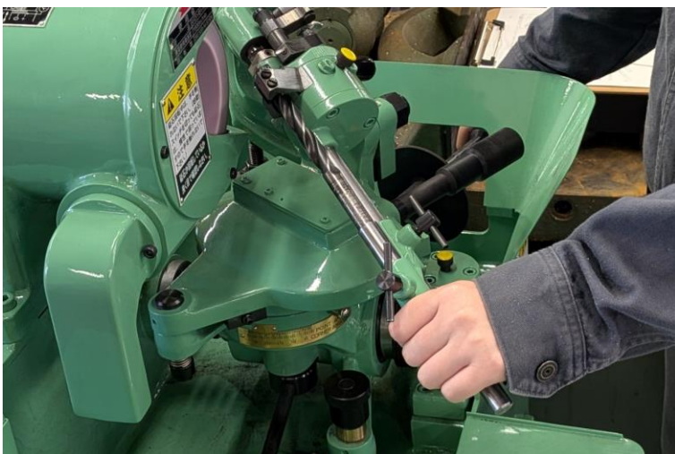
ドリル研削盤でドリルの先端を研磨
