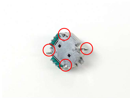
図 4 ジョイスティックの切断箇所
