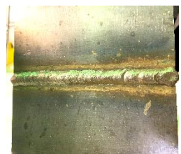
中央の盛り上がった部分が溶接したところ
