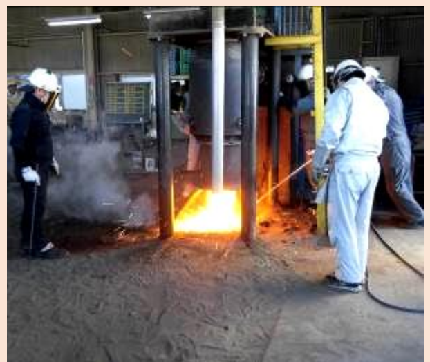
鑄込み終了「炉底を開き残ったコークスやくず鉄を出し、水で冷やす。」
