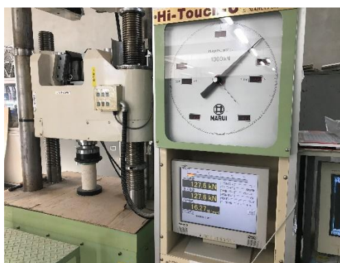
材料試験(コンクリート圧縮試験)実習
