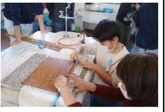
巻きすについた紙素をはがし、重ねてしばらく置き、水分を抜きます。 |
