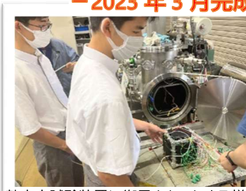
熱真空試験装置に衛星をセットする様子
